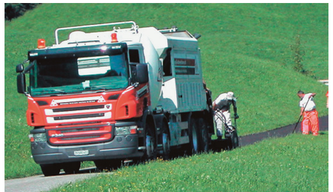
10. Bergstrasse: Die hochkompakte 4-Achsmaschine mit drei gelenkten Achsen ist sehr wendig und gebaut für enge Kurven und beengte Verhältnisse in Dörfern und Städten.
